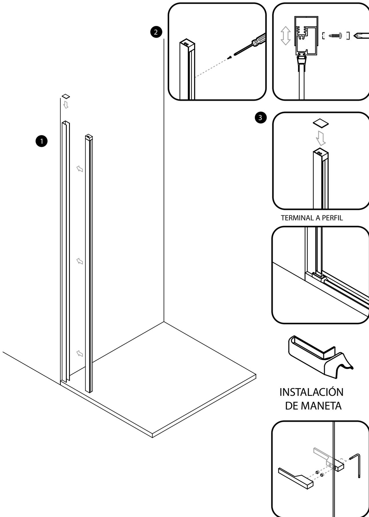
1. Insertamos la perfilera del cierre magnético en el marco expansor instalado previamente pegado a la pared con cinta doble cara
